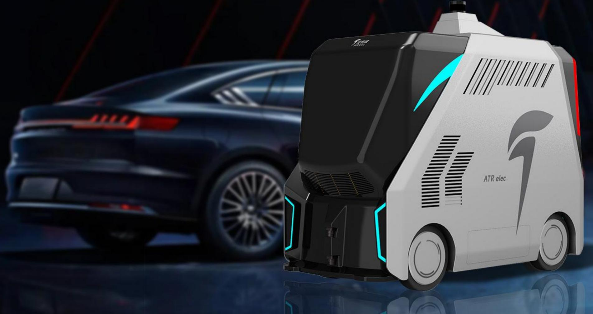
小智新能源无人智能充电车，自动移动、智能感知、自动定位待充新能源车。由“车找桩”变成“桩找车”，车主再也无需费尽心力找桩充电。小智充电车配备90度电池，国标直流快充，最快30分钟充至80%电量。为新能源车主带来高品质的无感充电体验，让充电不再焦虑。
